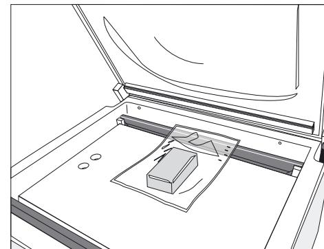
3- Démarrer le cycle d'emballage en fermant le couvercle (maintenir le couvercle fermé jusqu'à la sensation d'une succion).
